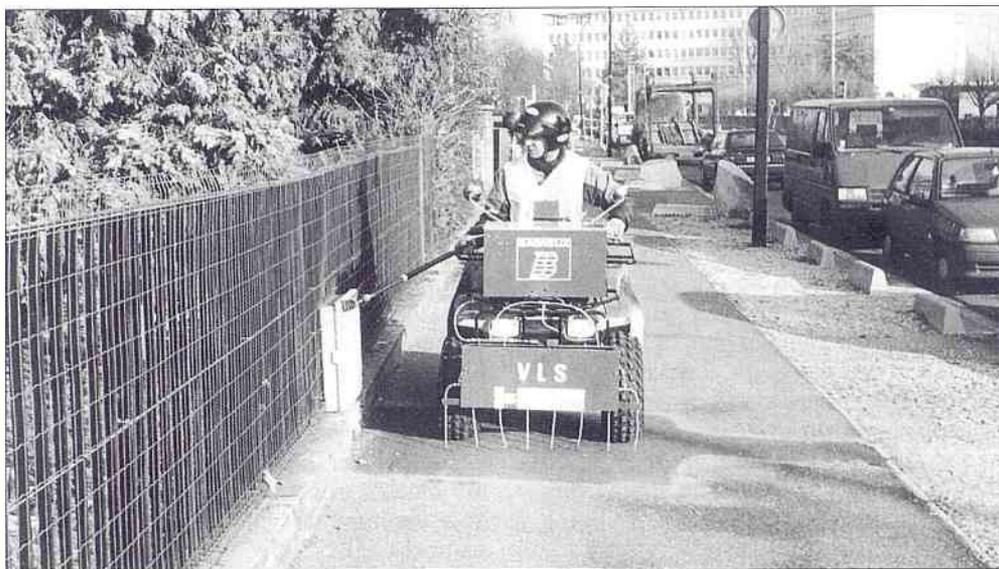
Le VLS, véhicule de surveillance des réseaux de gaz naturel.
